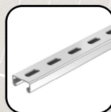
Профіль сталевий оцинкований (С-подібний 5x10x21x41x21x10x5)
